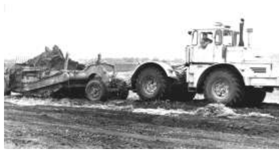
Fig. 1 Riempire il secchio maggiore capacità sul suolo argilloso
